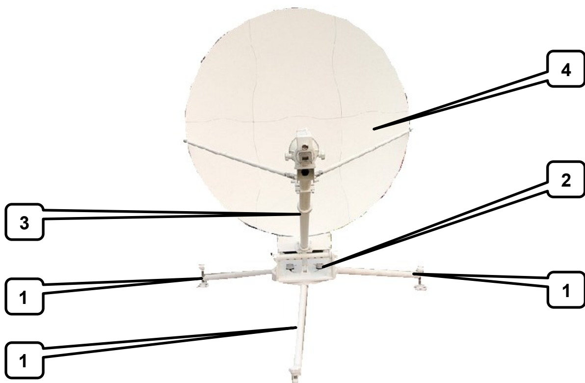
Рисунок 3 - Внешний вид антенной системы 1.2 м офсетной углепластиковой разборной с держателем облучающего устройства
